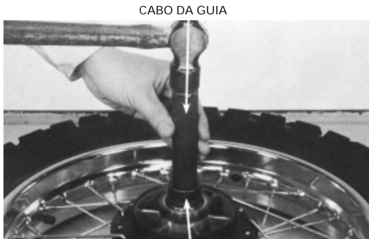
INSTALADOR DO ROLAMENTO (37 X 40 mm) GUIA 17 mm
